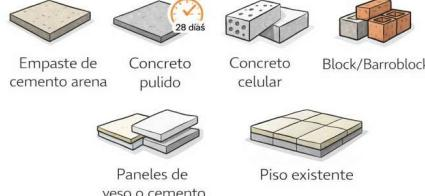
Sustratos apropiados: **Empaste** de cemento arena, concreto pulido (curado 28 días), **concreto celular**, block, barroblock, ladrillo, paneles de yeso o cemento y piso existente en interiores
