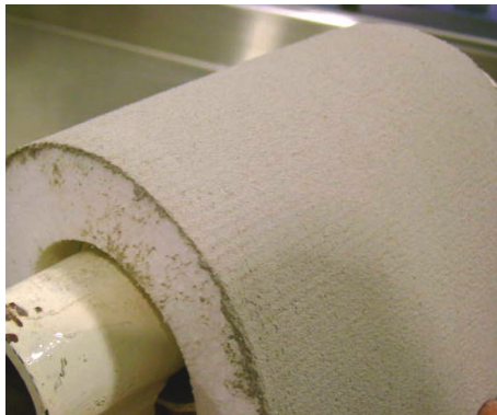
Prueba de Resistencia a la Flexión sin Agrietamiento
