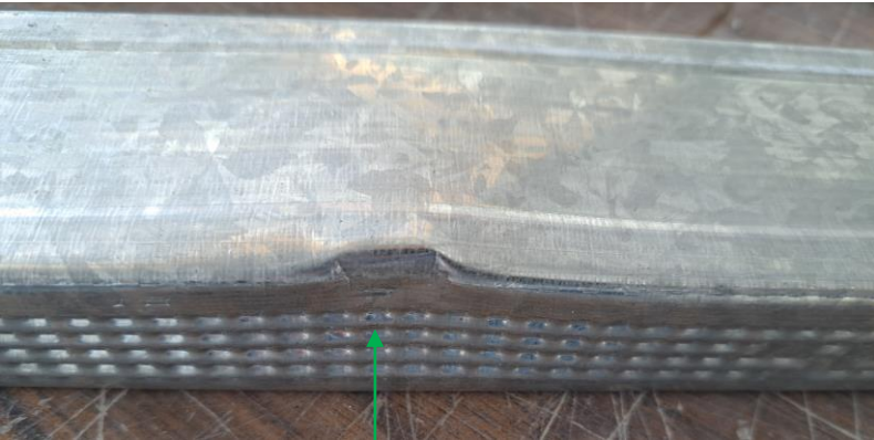
Perfil con ligera abolladura que no altera su estabilidad.
