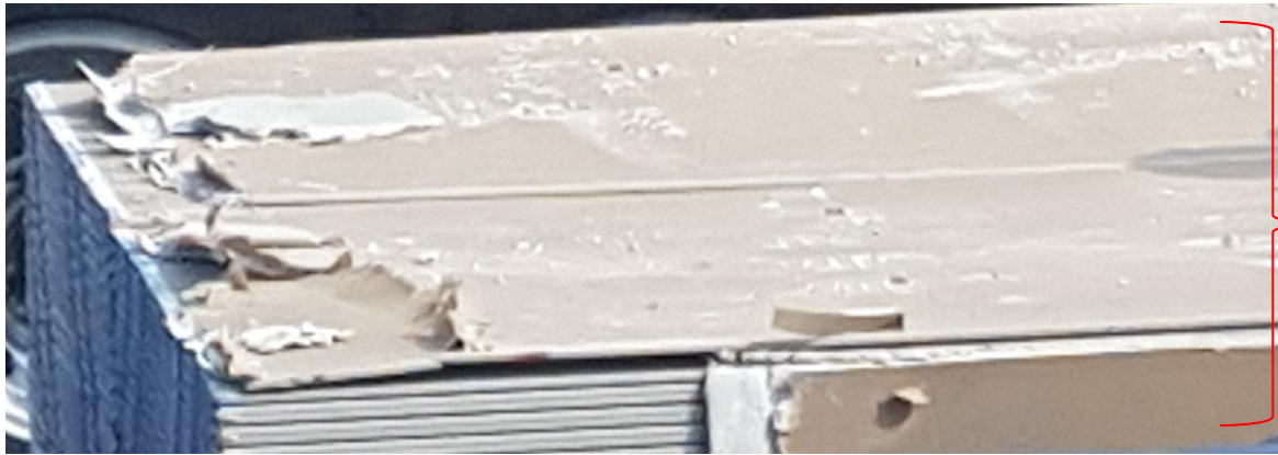
Ejemplo de Panel de Yeso, con núcleo pulverizado (en superficie).
