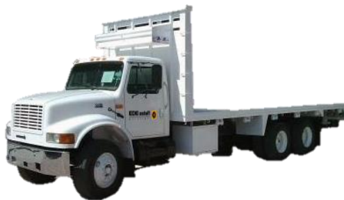
Torton con Plataforma de 23, 20, 18 o 16 ft. -Capacidad: 600 a 750 Paneles de 1/2".
